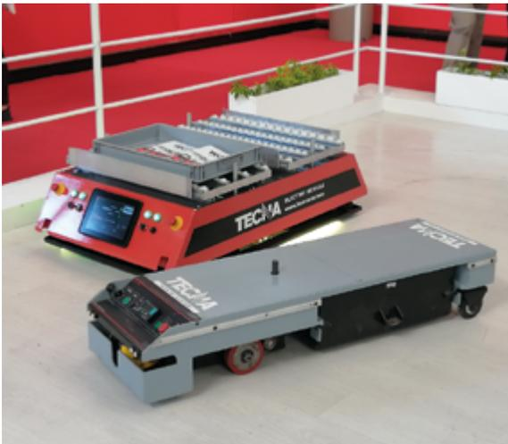
Vehículo eléctrico de la marca TECNA, encargado de transportar objetos automáticamente. El vehículo puede evitar objetos que impiden su paso y recalcular la trayectoria a su destino.
